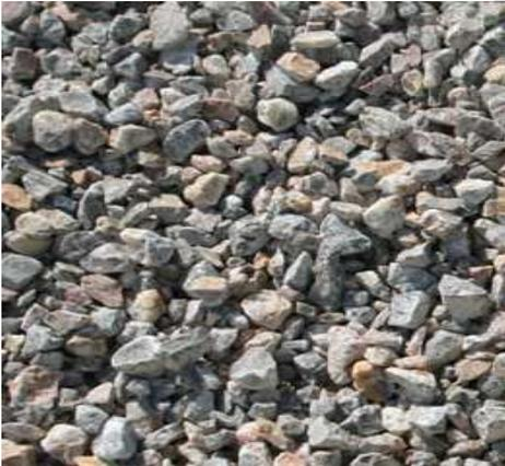
Les graviers peuvent être obtenus par concassage/criblage pour les bétons ou par extraction/criblage pour les graves de carrière.
